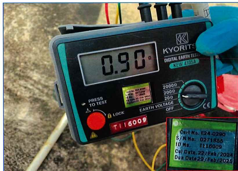
รูปการตรวจสอบความต้านทานสายดิน
