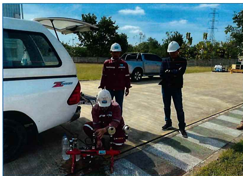
รูปการทดสอบ Safety Relief Valve
